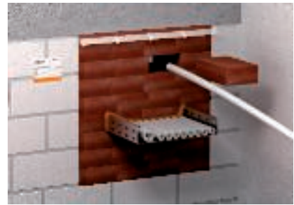
Egyszerű átalakítás a blokkok kihúzásával
