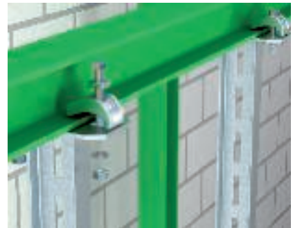
Függesztőszerkezet acélhoz Nagyfeszítvú rendszerekhez alkalmazható függesztőszerkezet: IS 8 K fejlemez oszloppal; az acéltartóra történő szerelés nehéz kivitelű szorítókörmökkel.
