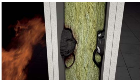
Szemléltetőkép a gipszkarton doboz viselkedésére a tűz során.
